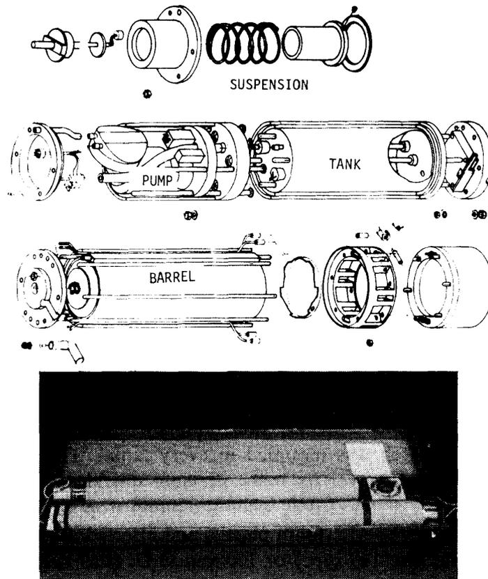
Fig. 11. JARE 140 Mk II thermal drill.
