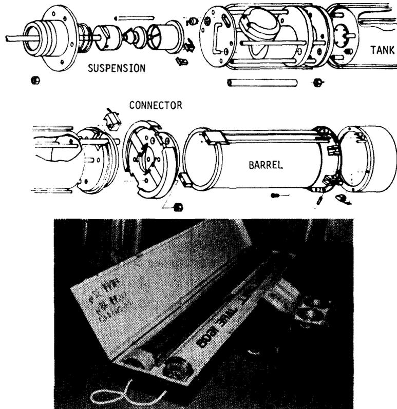
Fig. 13. JARE 160B thermal drill.
