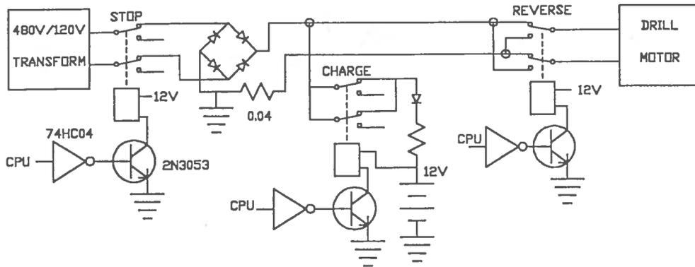
FIGURE 7. DIAGRAM OF HIGH POWER CIRCUIT IN DRILL
