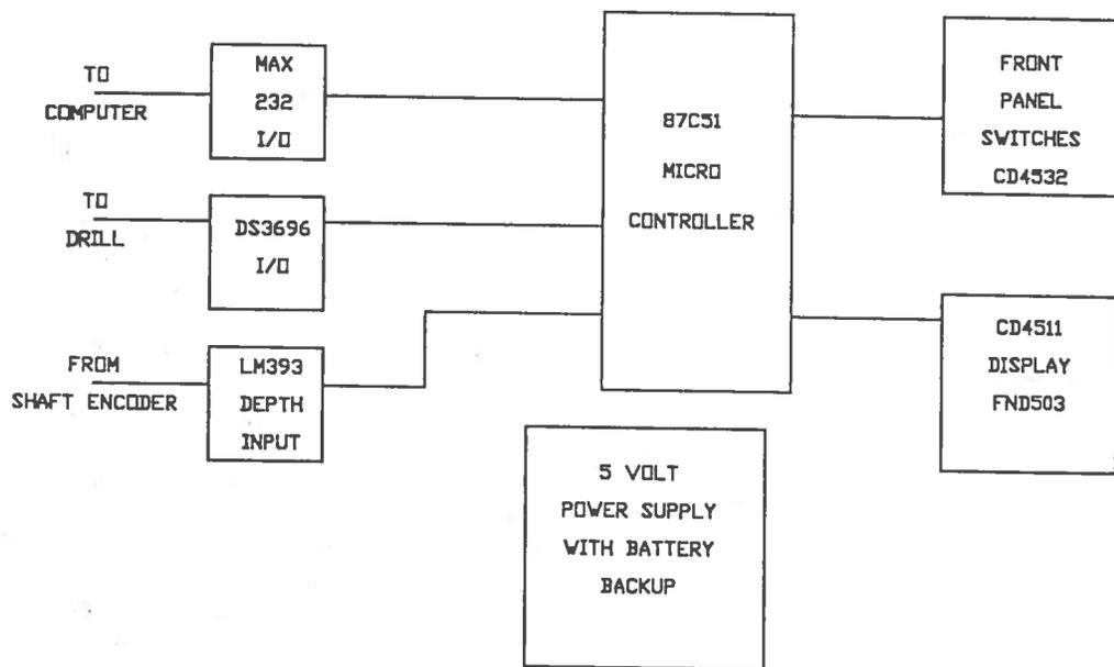
FIGURE 10. BLOCK DIAGRAM OF CONTROL PANEL CIRCUIT
